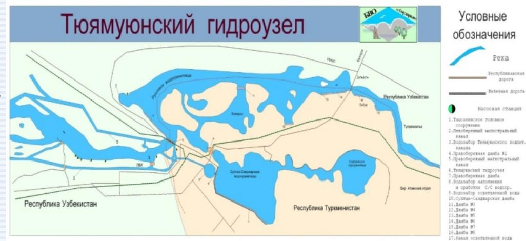
Актуальной является задача правильного расчета потерь воды из водохранилищ ТМГУ. Потери воды из водохранилищ ТМГУ на испарение и фильтрацию при существующем режиме наполнения и сработки водохранилищ в маловодные годы -  $0.7..0.9 \text{ км}^3$ , в многоводные – до  $1.5 \text{ км}^3$ . (Оценка, по зависимостям, разработанным в НИЦ МКВК)
